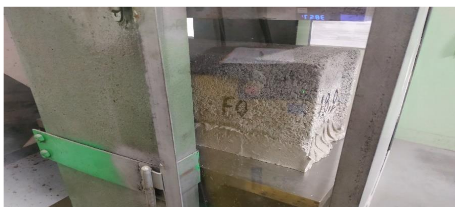
Figure 3. Exemple de bloc passé à la presse après surfacage (Formule F0)
