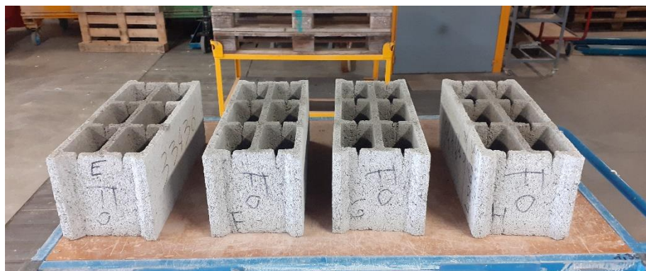
Figure 4. Bloc F0 après 25 cycles de gel-dégel
