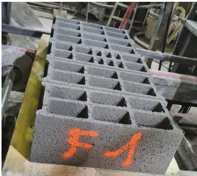
Figure 2. Blocs béton avec 50 % de substitution en GBRC sur la ligne de production
