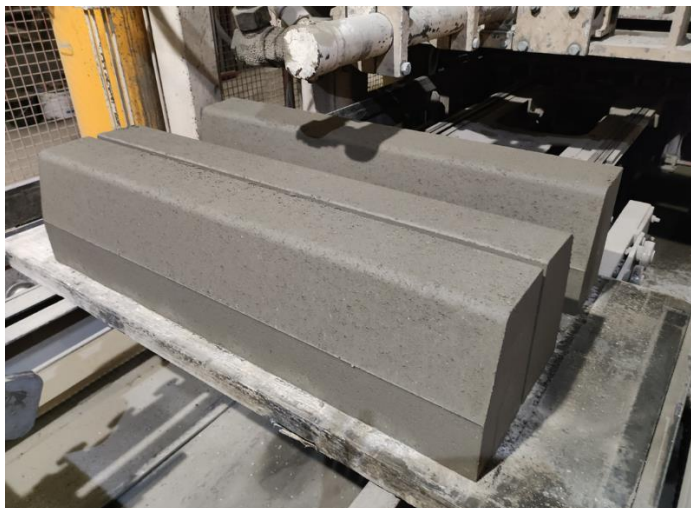
Figure 6. Bordures avec 50 % de sable recyclé carbonaté sur la ligne de production
