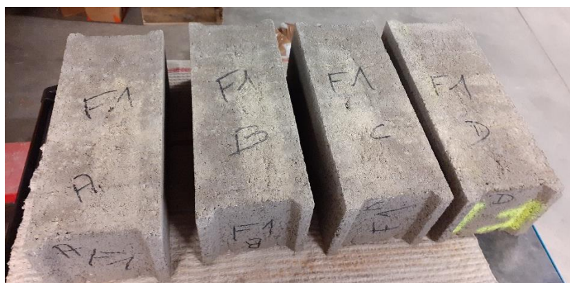
Figure 5. Bloc F1 après 25 cycles de gel-dégel
