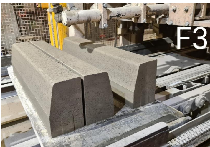
Figure 7. Bordures avec 100 % de sable recyclé carbonaté sur la ligne de production
