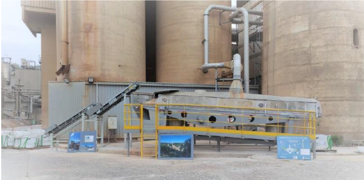
Figure 5. Pilote FastCarb de Val d'Azergues (procédé Lafarge)
