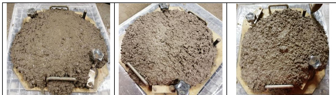
Béton B6 des 3 gâchées à T15 min
