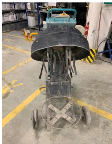
Figure 1. Malaxeur Collomix utilisé pour les gâchées de calage et de caractérisation
