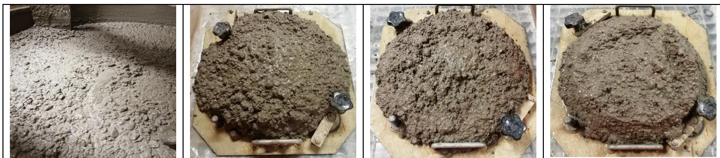
Béton B4 des 3 gâchées à T15 min
