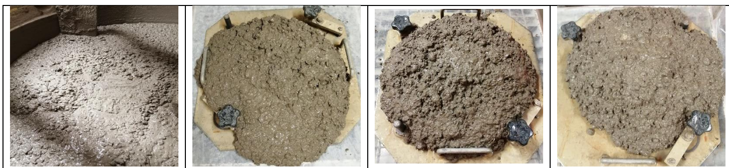
Béton B5 des 3 gâchées à T15 min
