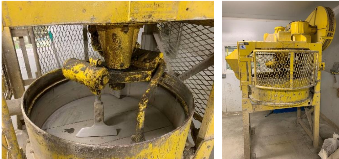
Figure 2. Malaxeur Skako-Couvrot utilisé pour la fabrication des éprouvettes de durabilité
