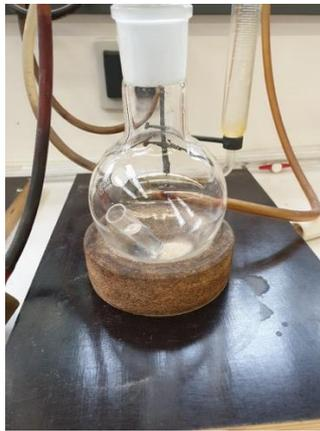
Figure 8 Calcimètre de Bernard Echantillon avec une dose d'acide chloridrique
