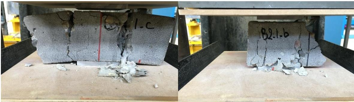
Figure 3 : Essai de compression (post-flexion) des BT19
