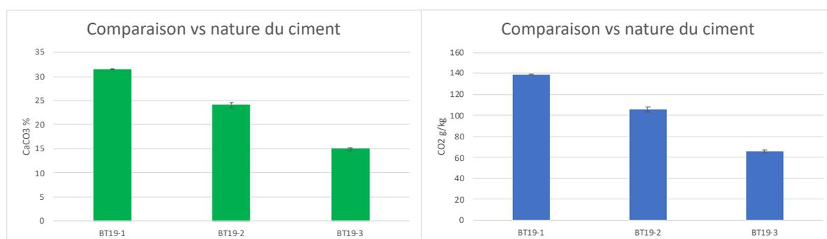
Figure 52 Teneur en  $\text{CaCO}_3$  ou  $\text{CO}_2$  des BT19 -1 à 3 carbonatés
