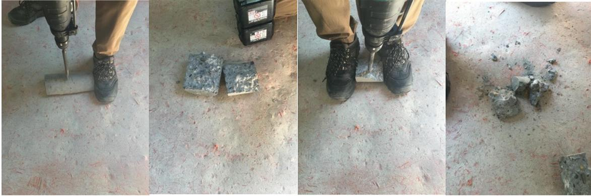
Figure 2 : Pré-concassage des BT19
