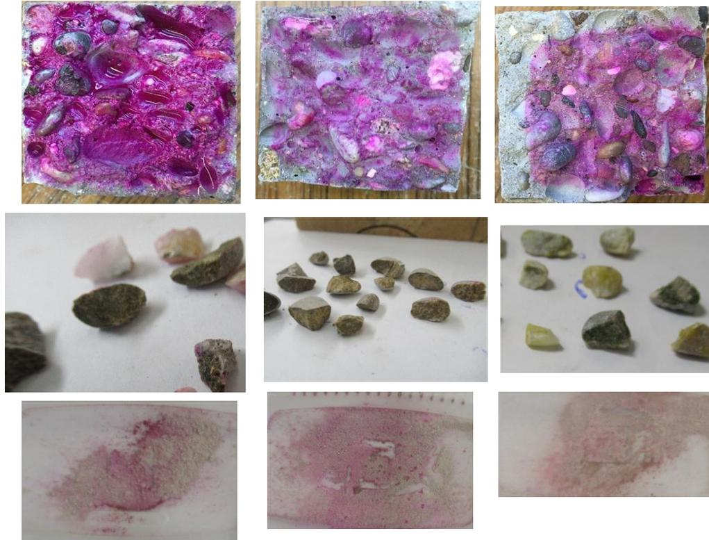
Figure 49 Contrôle pH sur échantillons non carbonatés BT19-1 (gauche) ; BT19-2 (milieu) ; BT19-3 (droite)
