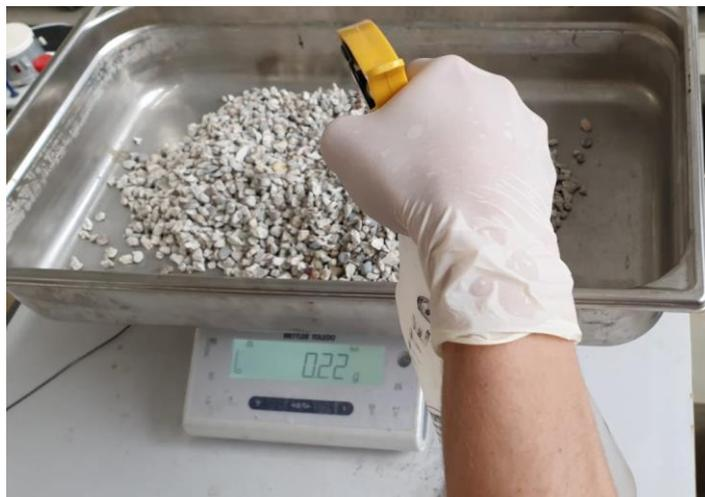
Figure 6 humidification des granulats secs avant carbonatation
