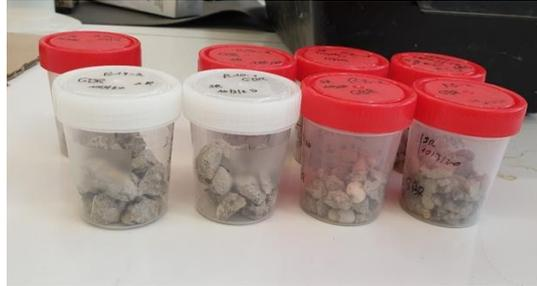
Figure 60 Echantillonnage pour l'essai d'absorption et masse volumique
