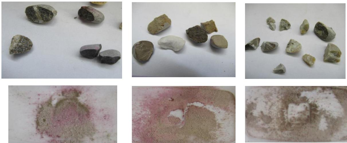
Figure 51 Contrôle pH sur échantillons carbonatés BT19-1 (gauche) ; BT19-2 (milieu) ; BT19-3 (droite)
