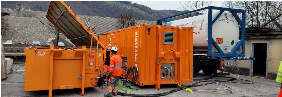
Figure 7. Système de carbonatation mis en œuvre par Neustark. Source : https://www.greaterzuricharea.com/en/news/holcim-drives-forward-start-ups-innovations ©Holcim
