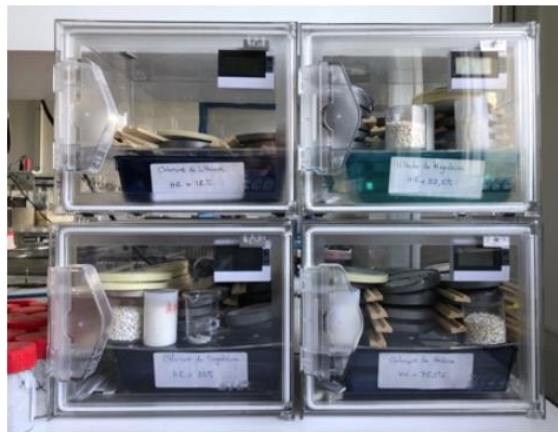
Figure 1. Vue des dessiccateurs utilisés pour la détermination des isothermes (Gendron, 2019).
