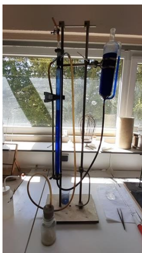
Figure 8 : Calcimètre de DietrichFrühling, vue d'ensemble et Cellule de réaction échantillon-acide (Bernard)
