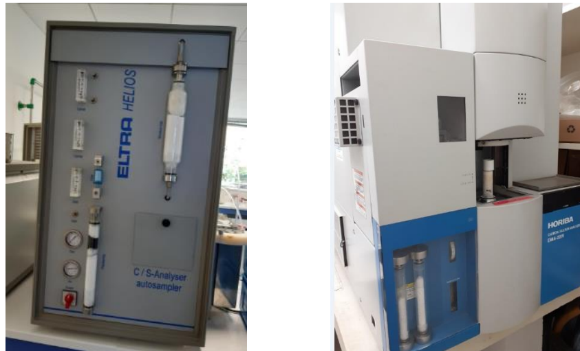
Figure 10 : Equipements pour la mesure du Carbone Total
