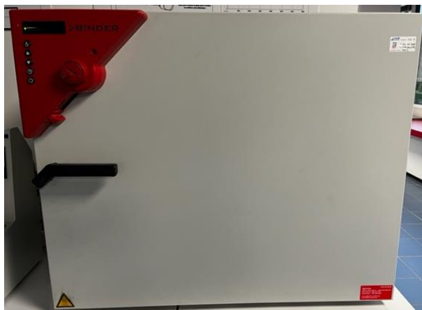
Etuve utilisée à 60°C et 80°C pour le séchage des échantillons
