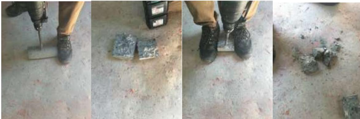
Figure 9 Pré-concassage – réduction de la blocométrie des BT19
