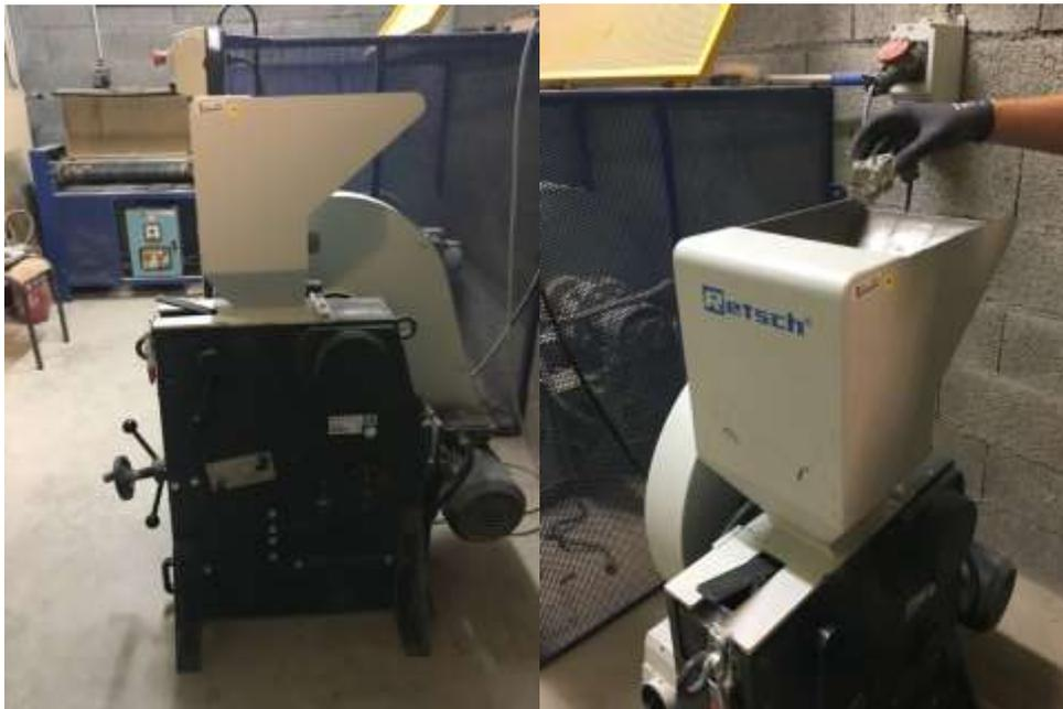
Figure 7 Concasseur à mâchoires utilisés pour les MR20 et BT19
