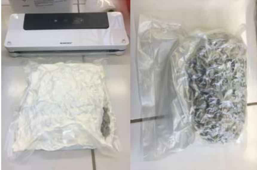
Figure 13 Mise sous vide des échantillons après échantillonnage
