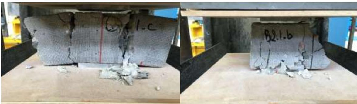
Figure 10 Essai de compression post essai de flexion BT19 avant concassage
