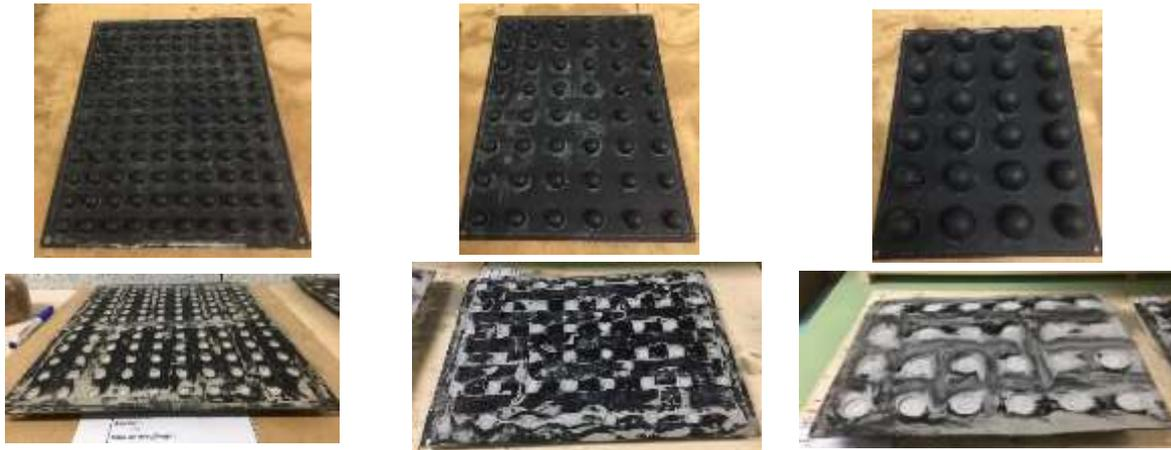
Figure 2 moules utilisés pour la fabrication des échantillons sphériques
