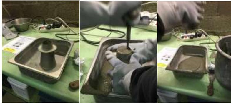
Figure 4 Essai d'affaissement au mini cône
