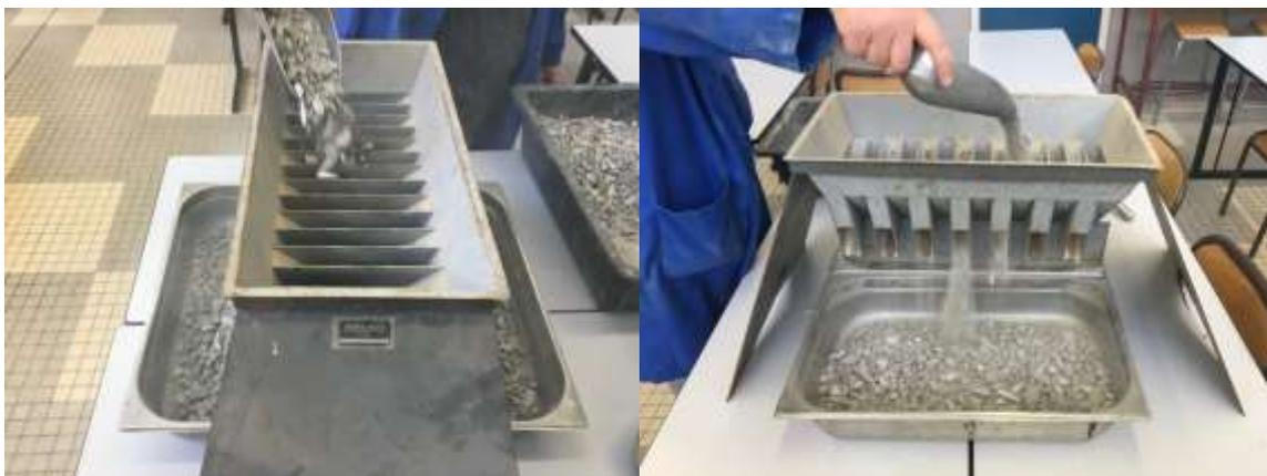
Figure 12 échantillonnage des matériaux avant mise sous vide
