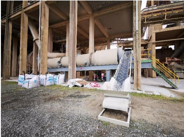
Figure 6. Démonstrateur VICAT – trémie de chargement
