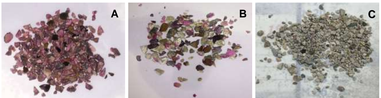
Figure 4 : Pulvérisation à la phénolphtaléine des 3 types de GR (A : Longrines 1-4, B : RB 1-4 concassé, C : RB 1-4)
