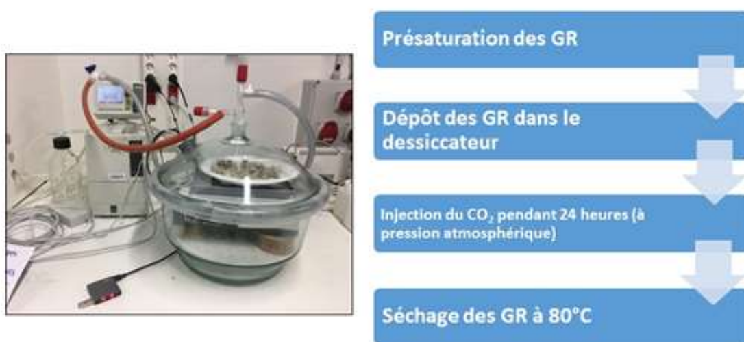
Figure 2 : Procédé de carbonatation accélérée des GR
