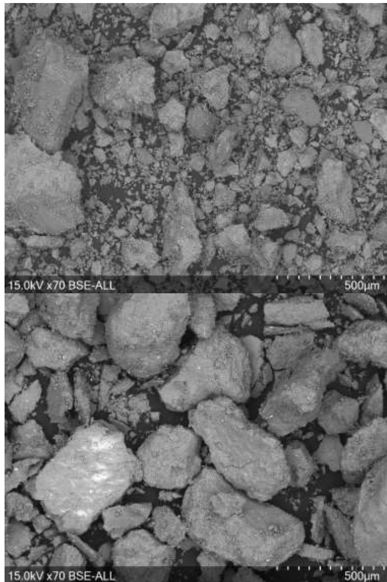
Figure 18. Images SEM de particules fines non carbonatées (haut) et carbonatées (bas)
