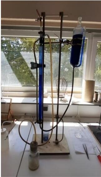
Fig 1 – Vue d'ensemble d'un calcimètre
