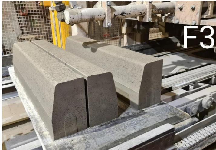
Figure 33 Bordures avec 100% de sable recyclé carbonaté sur la ligne de production
