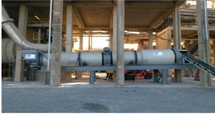
Figure 19 Pilote FastCarb – Tambour sécheur, usine Vicat de Créchy (Allier)
