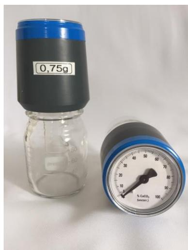
Fig 1 – Bombe à carbonate
