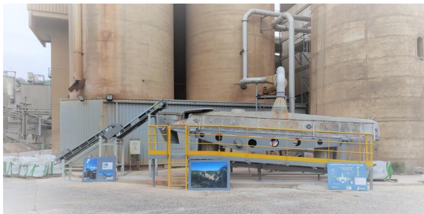
Figure 20 Pilote FastCarb – Sécheur à lit fluidisé, usine Lafarge de Val d'Azergues (Rhône).
