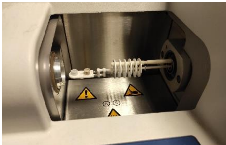
Figure 1 : Echantillon sur micro balance ATG masse 50-80 mg
