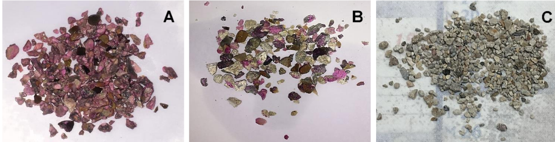
Figure 8 Pulvérisation à la phénolphthaléine (A : granulats recyclés Longrines 1-4, B : granulats recyclés RB 1-4C, C : granulats recyclés RB 1-4)
