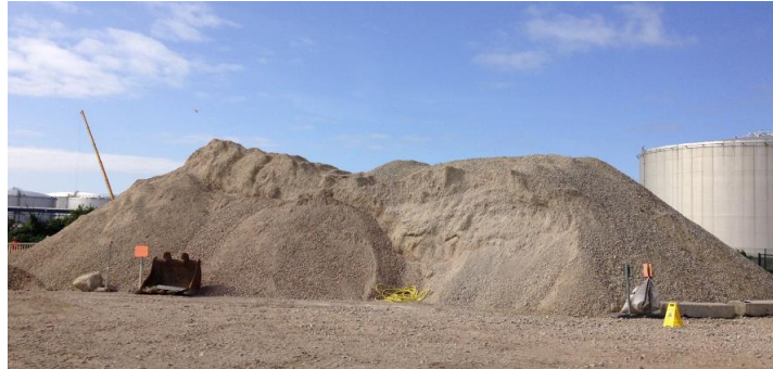
Figure 46 Tas de granulats recyclés issus du concassage de déchets inertes du BTP sur la plateforme Valosphère du groupe Spie Batignolles à La Rochelle (Hou et al., 2022)
