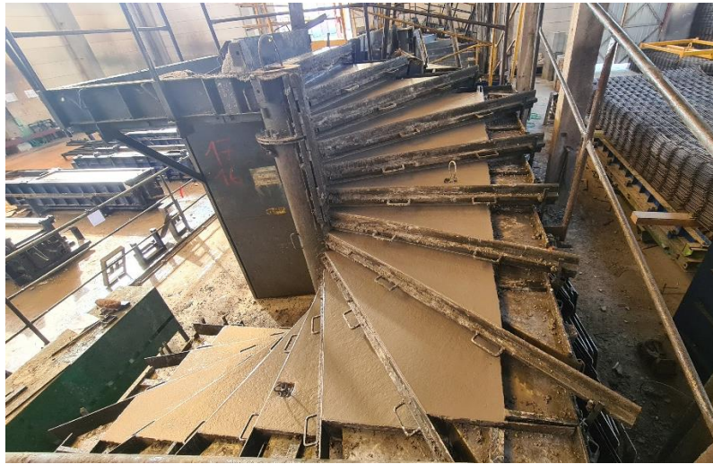
Figure 34. Fabrication d'un escalier en usine (71)
