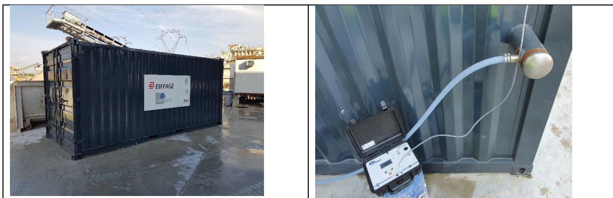
Figure 21 Vue du conteneur Clamens et de son système d'injection.
