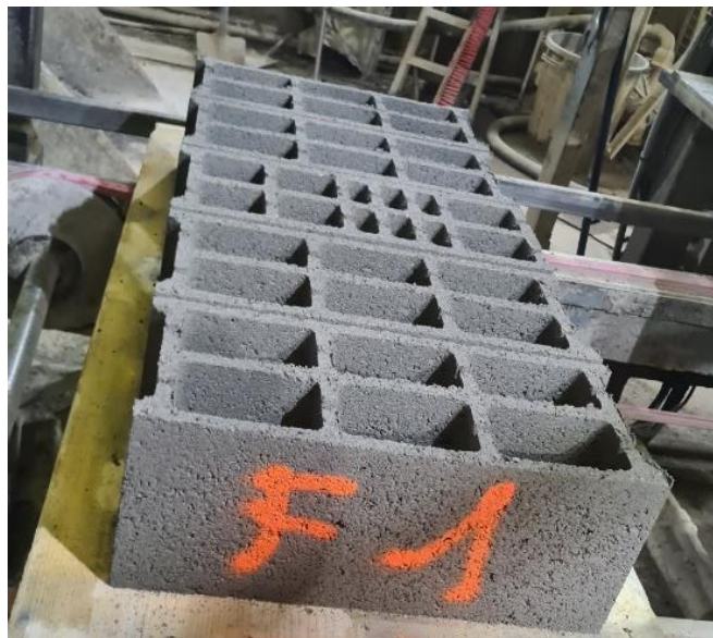
Figure 32 Blocs béton avec 50% de substitution en GBRC sur la ligne de production
