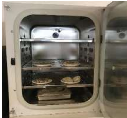
Figure 2 : Vue intérieure du dispositif de carbonatation accélérée
