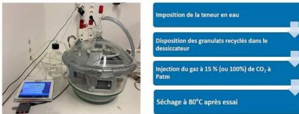
Figure 1. Procédé de carbonatation accélérée des GR (statique)
