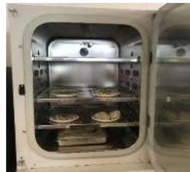
Figure 2 : Vue intérieure du dispositif de carbonatation accélérée
